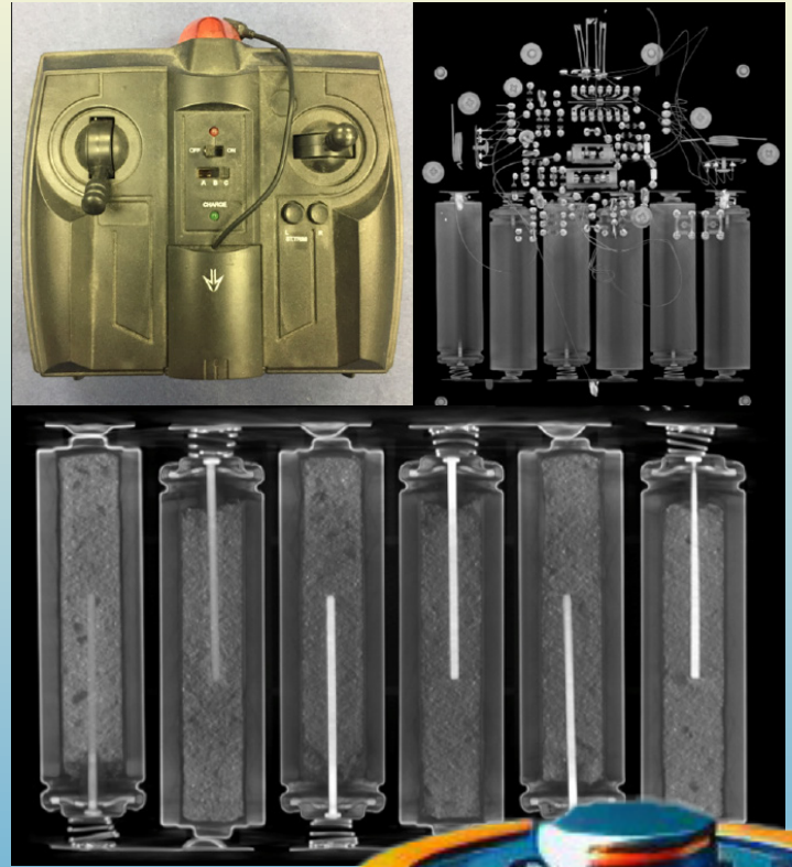
Figura 1: Foto, renderizado 3D y sección transversal virtual de un control remoto de juguete. Además de proporcionar información sobre los componentes electrónicos, la imagen de rayos X y la tomografía computarizada se pueden utilizar para identificar entre baterías primarias y secundarias.
