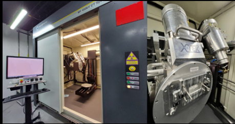
Figura 1. Microtomógrafo computarizado de fuente dual (225kV/450kV) del Centro Avanzado de Pruebas Analíticas No Destructivas de la BUAP.
