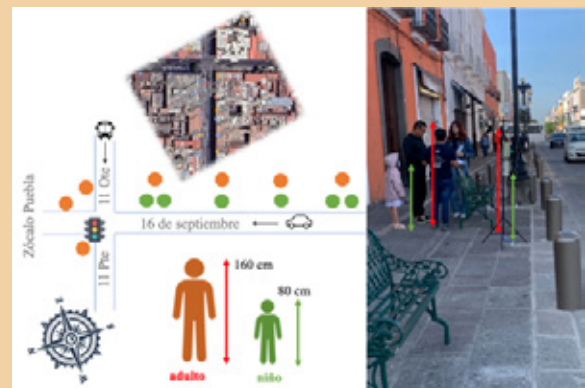
Figura 2. Esquema de la ubicación de dispositivos para medir partículas en aerosoles que respira un adulto (naranja) y un niño (verde).
