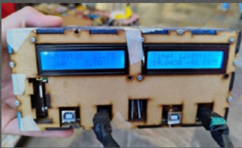
Figura 1. A la izquierda se muestra un dispositivo portátil y con autonomía (8h) que mide las concentraciones de partículas finas (PM 2.5 ) y gruesas (PM 10 ) y la localización del peatón durante los recorridos (derecha) a pie en calles y avenidas del Centro Histórico de la Ciudad de Puebla.
